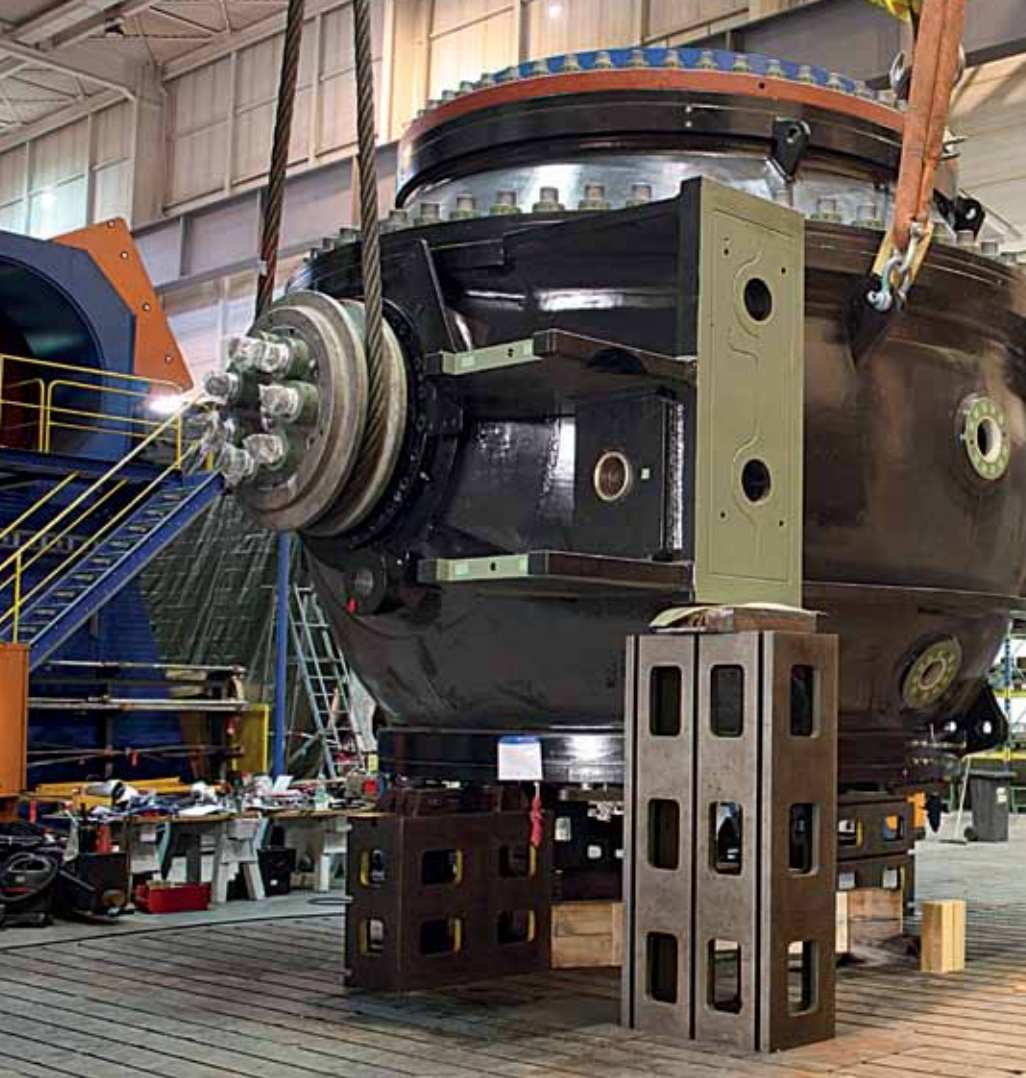
▲ Vanne sphérique pour la centrale hydroélectrique d'Herdecke lors des travaux d'assemblage en atelier
