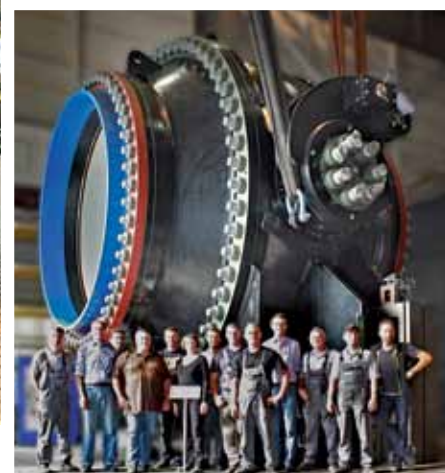
▲ Vanne sphérique pour la centrale d'Herdecke : fin des essais d'étanchéité après service
